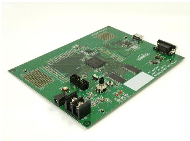
本製品はRH850/D1M1A ETSはルネサス製マイコン RH850/D1M1A (R7F701461)を搭載した評価ボードです。CAN通信、HDMI出力を備えており、車載ダッシュボードなど画像処理をはじめとした、さまざまな用途に向けてRH850/D1M1Aの評価を行うことができます。
