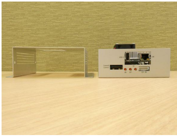
写真 6-10 上板を底板に被せます
