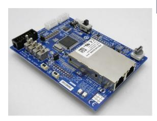
本製品はルネサスエレクトロニクス 製の産業用Ethernet通信モジュー ル (R-IN32M3 Module) を搭載した 評価ボードです。 MCUにRX66Tを搭載し、本ボード
