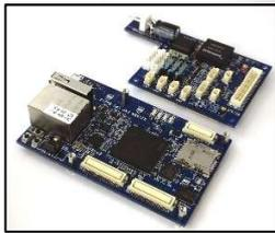
本製品はルネサスエレクトロニクス製マイコン (RZ/A2M) を搭載した2枚組の評価ボードです。
