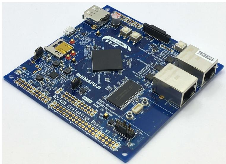
本製品はルネサスエレクトロニクス製CPU RZ/A2M(R7S921053VCBG)を搭載した評価ボードです。
