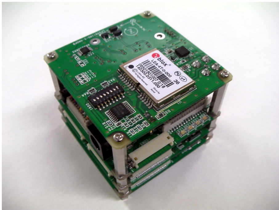
図1 Sylphide 外観 (以下の説明では上から何枚目のボードという表現を用いますが、その際はこの図のように設置した状態で基板を特定してください。全部で4枚のボードで構成されています。)
