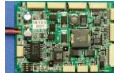
電源コネクタ未搭載のボードは基板に電源線を直接半田付けする必要があります。導体外形が 0.5 ~ 0.8 程度の線材をご使用下さい。
